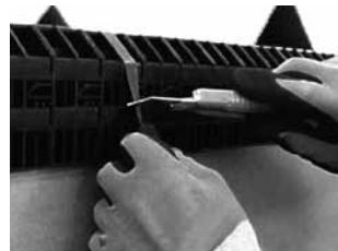
1. Zunächst die Folie greifen und mit einem Cuttermesser aufschneiden. Achten Sie darauf, dass die Klinge des Cuttermessers die Solarmodule nicht berührt.
